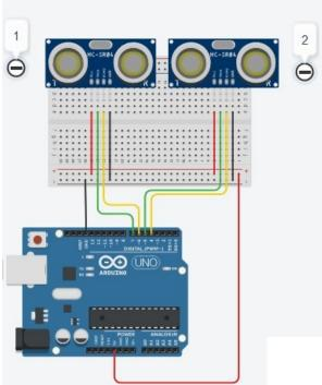
Progettiamo un dispositivo che conti il passaggio di persone da una porta d'ingresso di una banca incrementando un contatore. Se le persone escono dalla porta di uscita il contatore si decrementerà.
