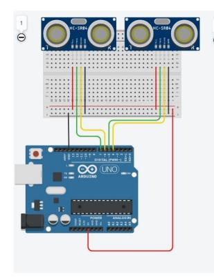
Come terzo step, progettiamo un controllo che con due SRF05 conti sia l'ingresso che l'uscita di clienti attraverso una singola porta.
