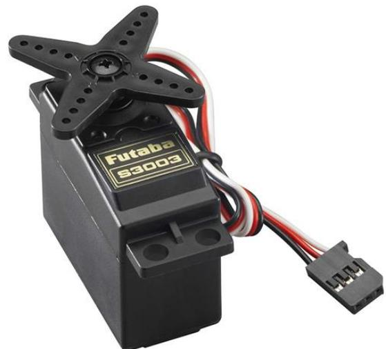
Per far girare il motore bisogna inviare un segnale digitale al circuito di controllo. Questo segnale è di tipo impulsivo, o PWM, e il suo valore varia tra  $500 \mu\text{s}$  e  $2500 \mu\text{s}$ . Gli impulsi rappresentano l'angolo di rotazione del perno.
