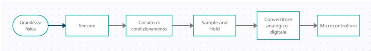
Nello schema a blocchi riportato sopra, possiamo vedere l'acquisizione dati del sensore che abbiamo utilizzato, dove:
