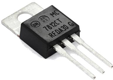
Un regolatore di tensione positiva, anche conosciuto come stabilizzatore di tensione, della serie 78xx, più precisamente 7812, è un componente elettronico integrato in grado di convertire una tensione continua in un'altra di più basso valore. Tutto questo vale anche per gli stabilizzatori di tensione negativi, gli LM79XX.
