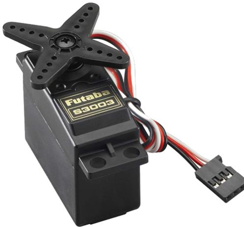
Un **servomotore** è un particolare tipo di motore che si differenzia dai motori tradizionali in quanto le sue condizioni operative sono soggette ad ampie e spesso repentine variazioni. Il **servomotore** si deve adattare a queste variazioni con la massima rapidità e precisione. Può essere elettrico, pneumatico, idraulico.
