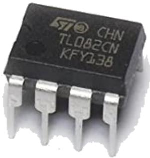
In elettronica, un **amplificatore operazionale**, in inglese *operational amplifier* oppure *op-amp*, è un amplificatore differenziale con una o più uscite. Grazie anche alla sua versatilità, è uno dei dispositivi più vastamente utilizzati sia in ambito commerciale, che scientifico, in particolare nei circuiti analogici e in circuiti riguardanti segnali acustici.
