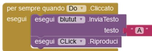
Dopo di esso ci sono i bottoni che mandano un carattere ad arduino attraverso il modulo **HC-05**. Questi caratteri verranno analizzati e utilizzati dentro uno switch case che andrà a comandare il servo, se si vuole usare il pan tilt normalmente. In questo caso il carattere A corrisponde a una coppia di valori diversi che sono stati calcolati apposta per puntare su un punto predefinito.
